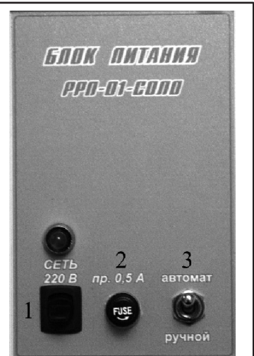
Рис. 6. 1 — переключатель сети 220 В; 2 — предохранитель 0,5 А; 3 — переключатель на два положения: 1 — режим автоматический, предназначен для управления исполнительными механизмами от прибора «РРП-01-СОЛО», 2 — ручной режим предназначен для отключения внешнего реле исполнительных механизмов от прибора
