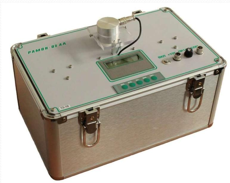
**Прибор предназначен для измерения долгоживущей активности альфа-активных аэрозолей и радионуклидов, содержащихся в воздухе на предприятиях добычи и переработки урана, на объектах нефтегазового комплекса, на горнодобывающих предприятиях, в рудниках, шахтах, на полиметаллических комбинатах и т.д.**
