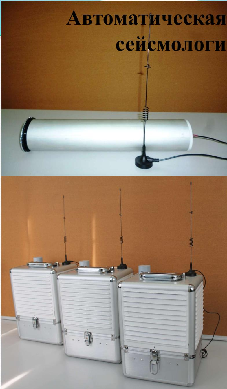
**Автоматическая система экологического и сейсмологического мониторинга состоит из достаточно густой сети наземных датчиков поверхностного уровня радона, долгоживущей активности, пылерадиационного фактора, радиоактивных аэрозолей и радионуклидов, находящихся в воздухе установленных в репрезентативных точках и центрального пункта, куда по радиоканалу поступает информация с каждого датчика.**
