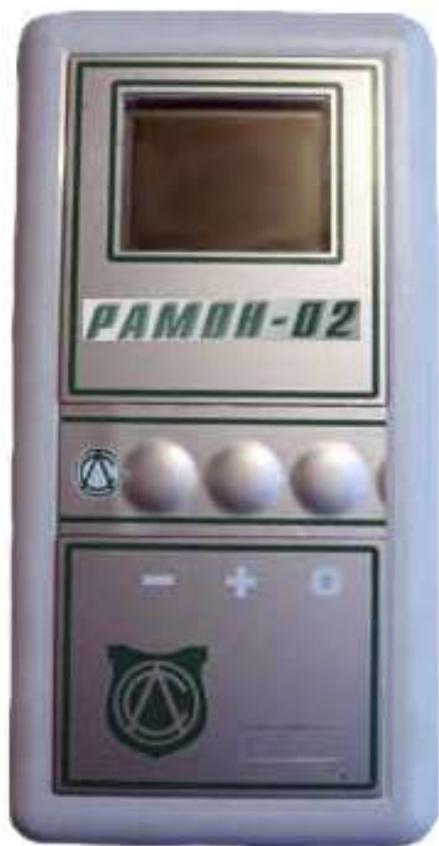
**Радиометр радона и его дочерних продуктов распада «РАМОН-02» предназначен для экспрессного определения эквивалентной равновесной объемной активности (ЭРОА) радона  $Rn222$ , величины «скрытой энергии» дочерних продуктов распада радона (ДПР) и торона  $Rn220$  (ДПТ).**
