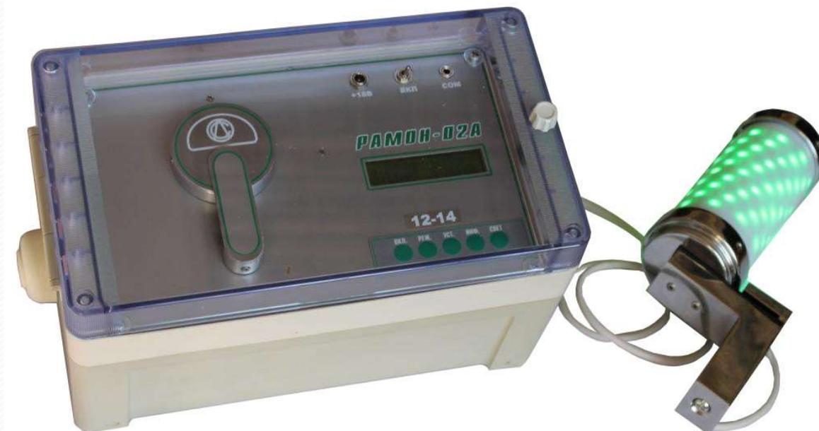
**Предназначен для автоматического мониторинга содержания эквивалентной равновесной объемной активности радона и торона в воздухе.**
